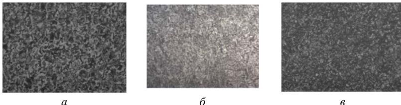
Рис. 1. Микроструктуры стали 35 а – после нормализации (x100); б – после закалки (x500); в – после высокого отпуска (x200)
